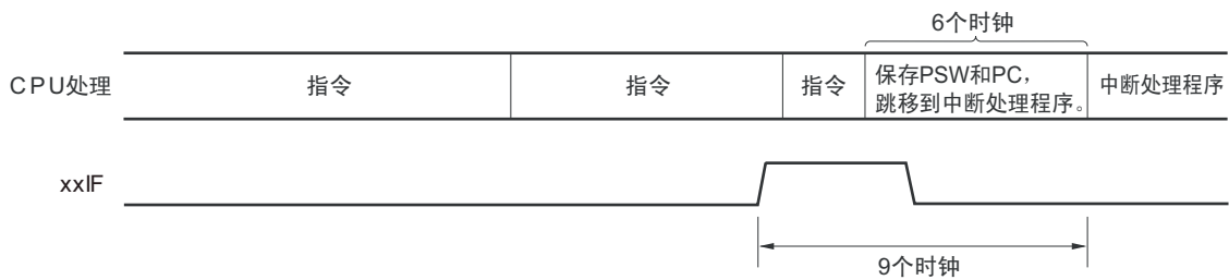
图 21-8 中断请求的接受时序（最短时间）
