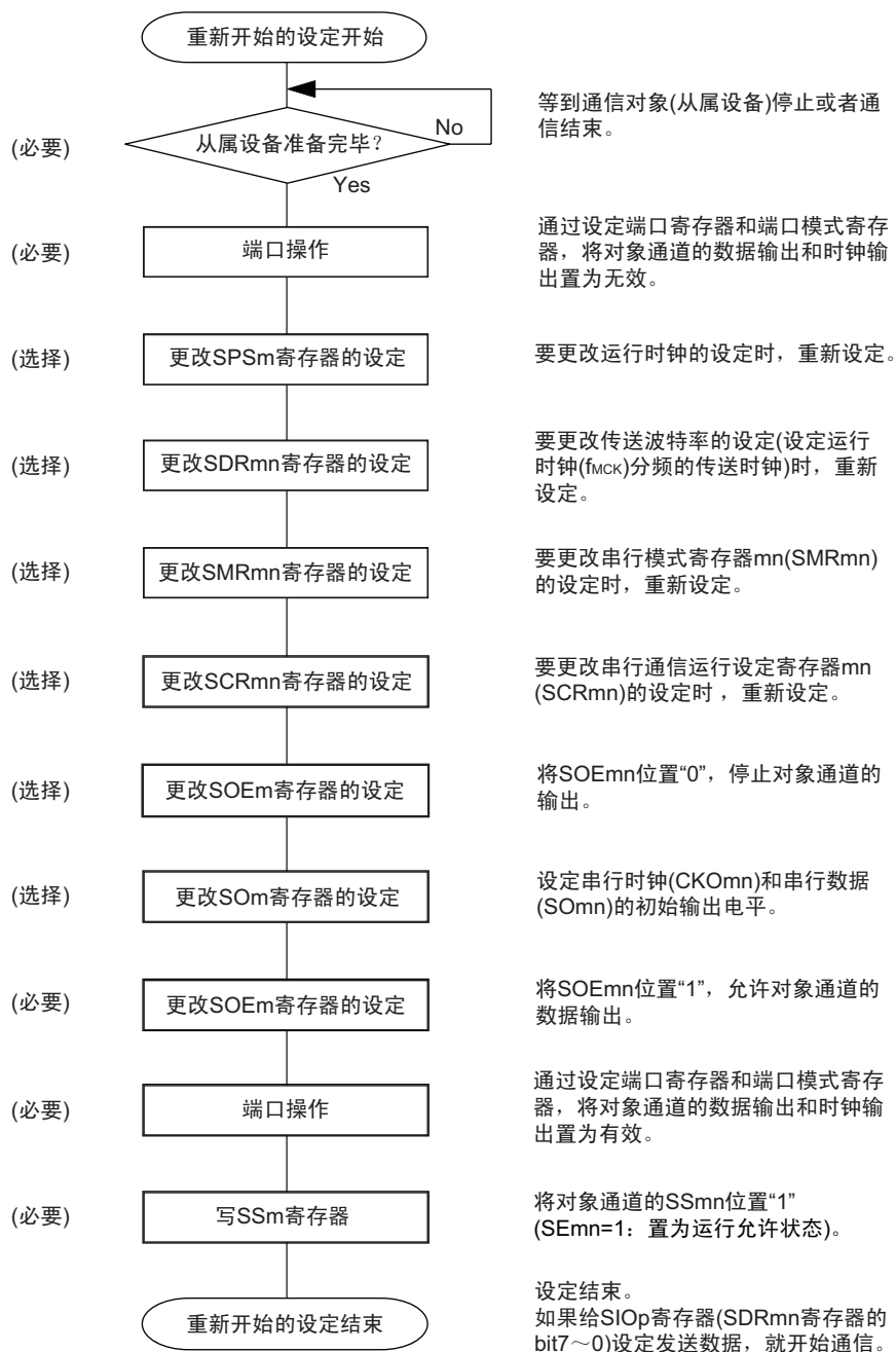
图 17-28 重新开始主控发送的设定步骤
