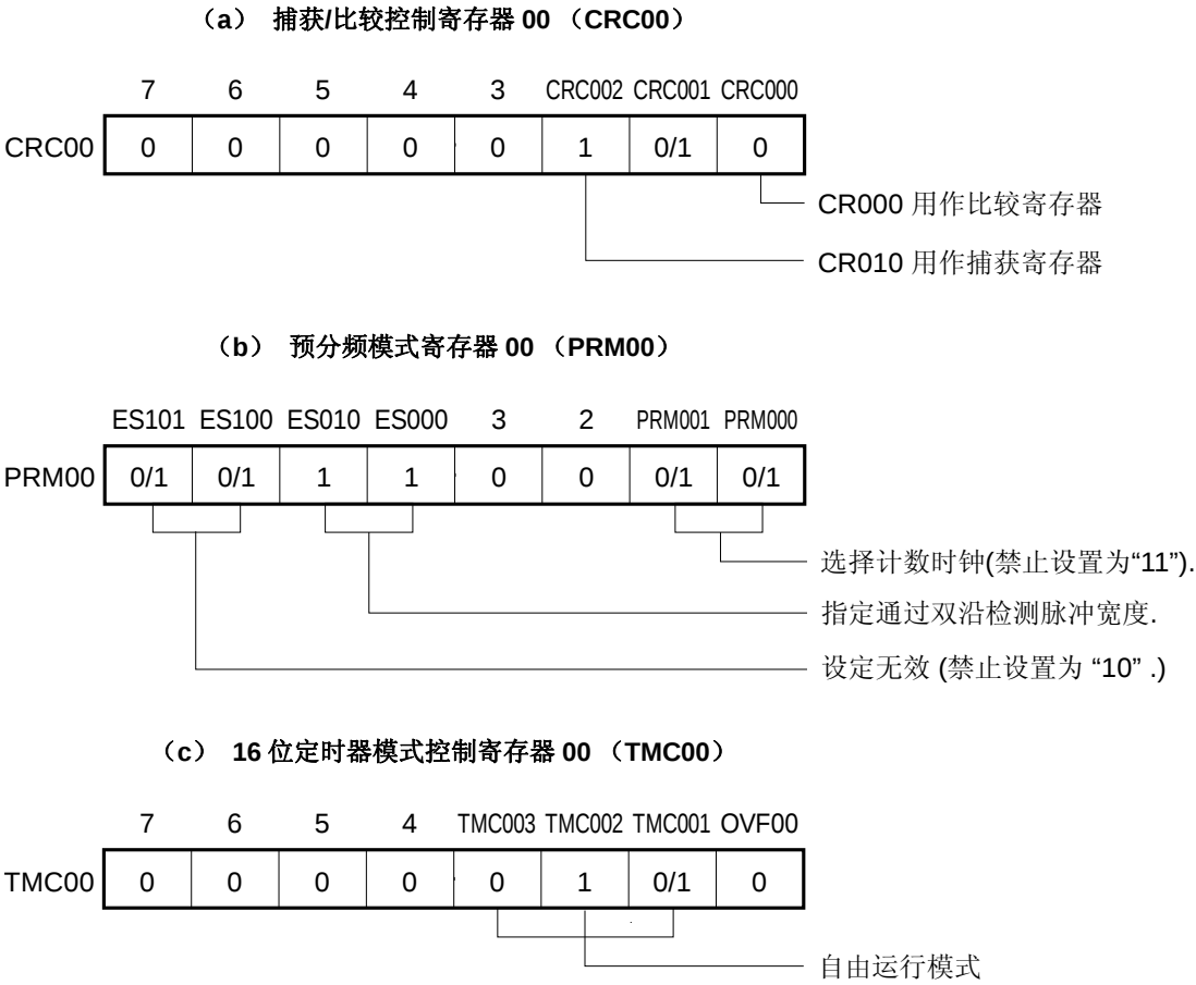
图 6-18. 通过自由运行计数器和一个捕获寄存器测量脉冲宽度的控制寄存器设置 (当使用 TI000 和 CR010 时)
